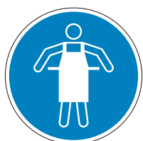
M026 Príkaz na používanie ochrannej zástery
