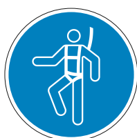
M018 Príkaz na používanie bezpečnostného závesného systému
